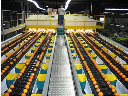
Figura 2.4a. Sistemas de clasificación de frutos por visión computacional
