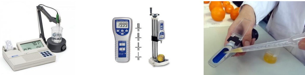
Figura 2.2. Muestra instrumentos de medición utilizados para medir firmeza, el contenido de sólidos solubles, la prueba de almidón y la acidez valorable de frutos.
